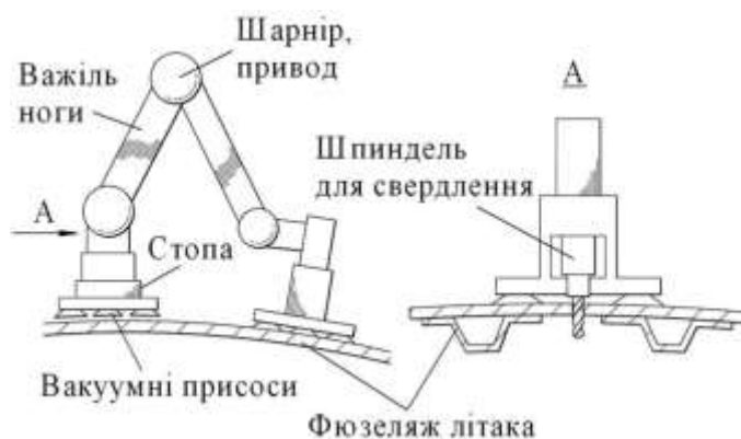
Рис. 1.12. Мобільний робот для обробки фюзеляжу літака [41]
