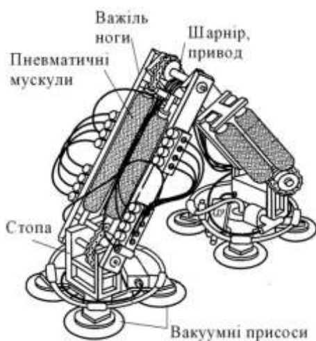
Рис. 1.11. Крокуючий мобільний робот з пневматичними мускулами [40]
