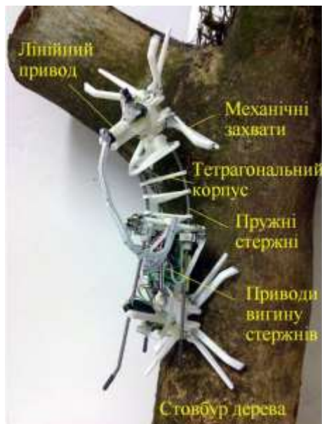
Рис. 1.9. Мобільний робот [11] для обслуговування деревних масивів (а) та залежність між кутом вигину хребта робота (б), силою зчеплення та зусиллями зсуву [38].
