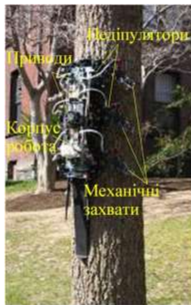
Рис. 1.8. The RiSE Climbing Robot (Boston Dynamics, Cambridge, USA) при переміщенні по дереву (а) і стіні (б)
